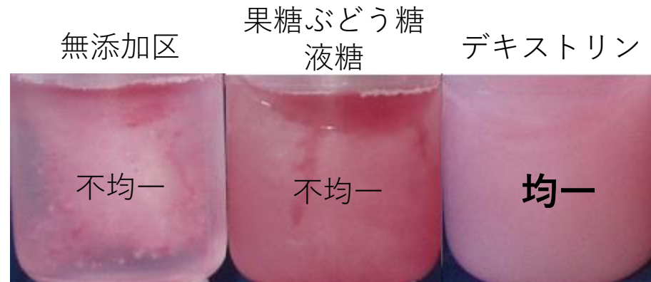
アントシアニン色素水溶液の凍結試験 (各種糖質5%添加)
