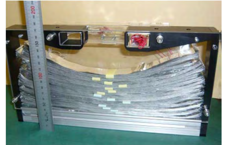
図3、一次元折りテープテザーの収納
