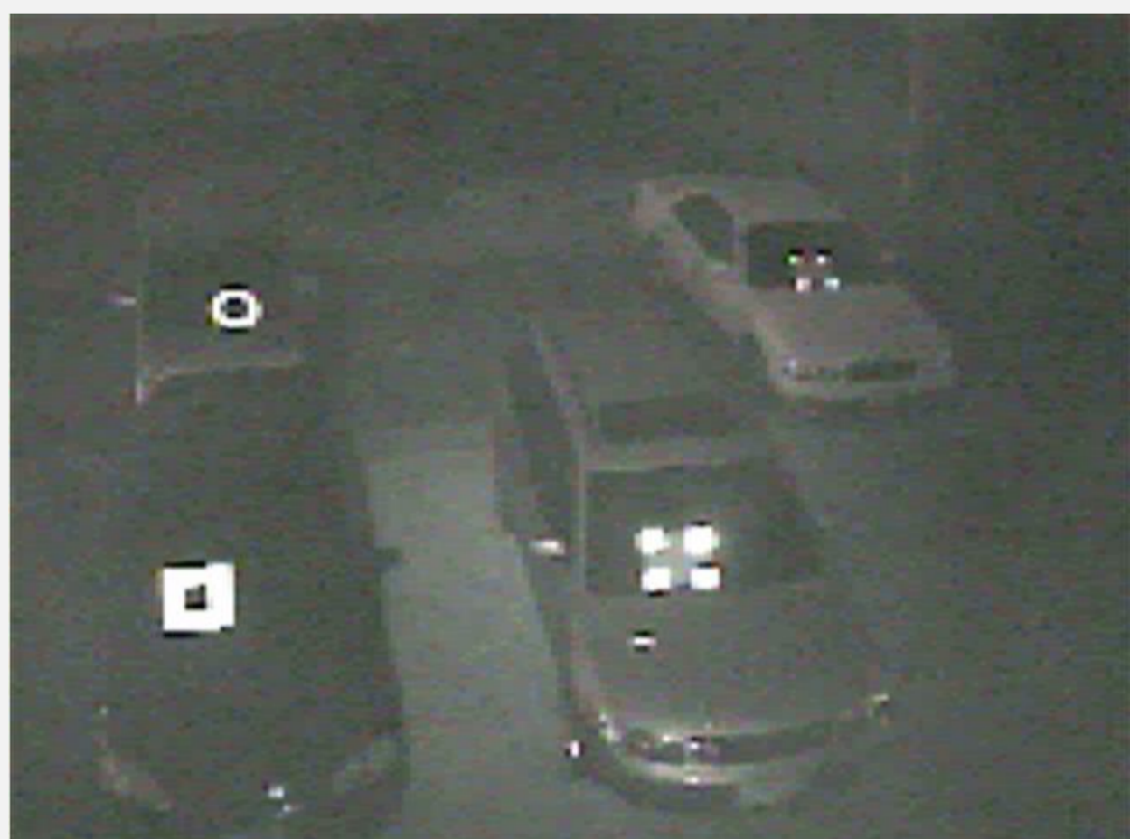
図1 IRカメラでフロントガラスに反射板を貼り付けた車を撮った画像
